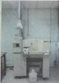
SAMPEL yang telah dituras akan dibaca menggunakan mesin ICP-OES.
